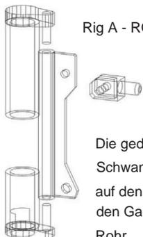
Die gedruckten Schwanenhalsteile werden auf den Mast geklebt und in den Gabelbaum eingeklebt Rohr.
