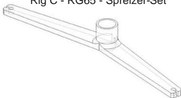
Die obere Saling hat eine umgekehrte Neigung, die dazu beiträgt, die Neigung des Mastes unter der Spannung des Riggs zu verringern.
